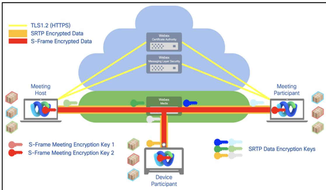
Für Webex Meetings, die eine höhere Sicherheitsstufe benötigen, bietet Webex zusätzlich eine Ende-zu-Ende-Verschlüsselung an. Mit dieser Option werden die Medienströme nicht in der Webex Cloud entschlüsselt, wie dies bei Standardmeetings der Fall wäre. Stattdessen wird ein TLS-Kanal für die Client-Server-Kommunikation erstellt. Zusätzlich generieren alle Webex Clients Schlüsselpaare und senden den öffentlichen Schlüssel an den Client des Meeting-Hosts.
